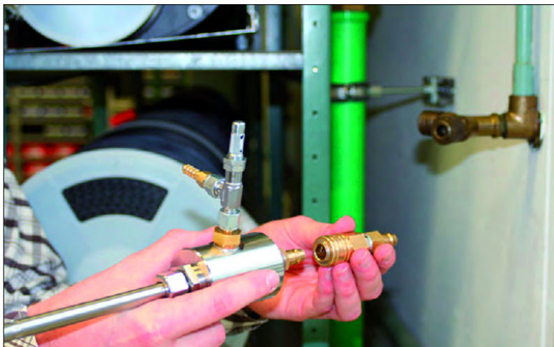
Připojení sondy zbytkové vlhkosti testo 6615 přes měřicí komůrku a filtr
